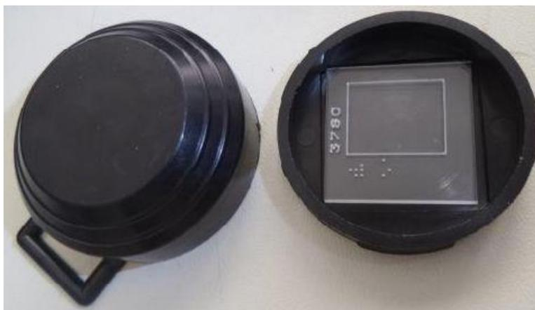
Figura 3: dosimetro di misurazione dell'attività radon indoor
