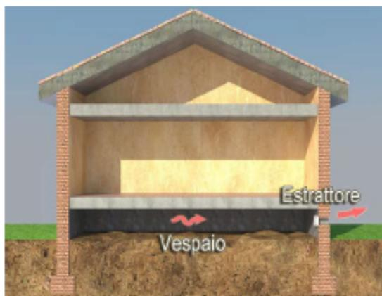
*Schema dell'intervento di ventilazione forzata del vespaio.*
